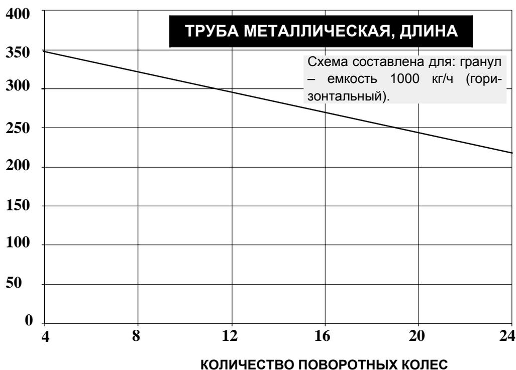
Для определения максимальной длины при заданном количестве поворотных колес (N) используйте следующую формулу:
