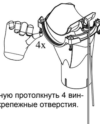
Вручную протолкнуть 4 винта в крепежные отверстия.
